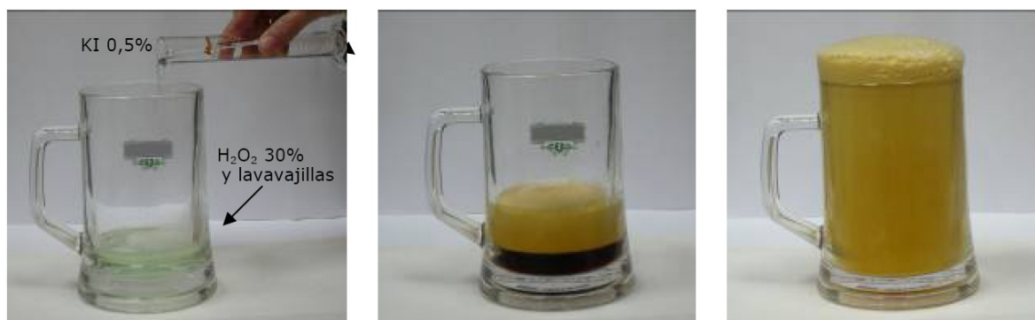
Figura 3. Al verter la disolución de yoduro de potasio sobre la de agua oxigenada con lavavajillas, la espuma asciende por la jarra hasta llegar a rebosar.
