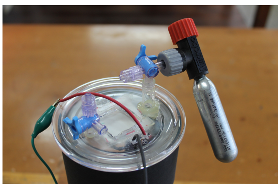
Figura 6. Una manera fácil de llenar el recipiente con CO 2 , mediante un cartucho usado para hinchar ruedas de bicicleta.
