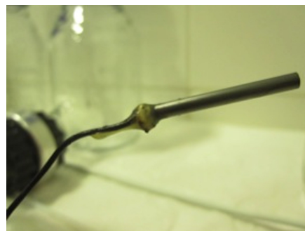
Figura 3. Mina de lápiz (grafito) pegada al cable.
