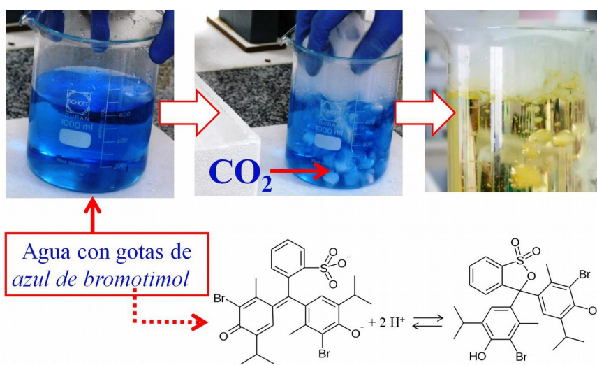
Figura 2. Resultado de la experiencia de añadir hielo seco en disolución acuosa ligeramente básica con unas gotas de indicador azul de bromotimol, del que se incluye su estructura molecular (en función del pH).
