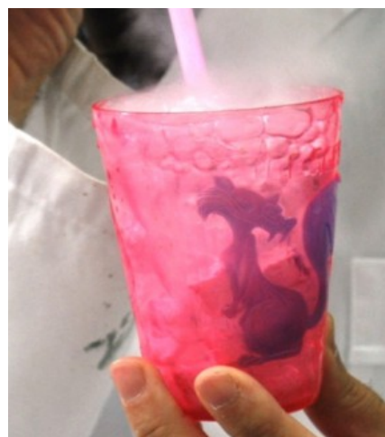
Figura 3. Cambio de color producido al enfriarse un envase termocrómico, inicialmente rosa a unos 22 °C, y en una pajita (también termocrómica) que al principio era blanca, al estar en contacto con agua sobre la que se añadió hielo seco. En el caso de la pajita, se debe sorber el agua con aspirador manual para pipetas, para evitar riesgos.
